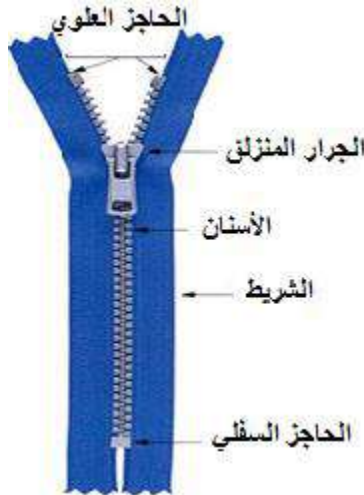
شكل (١) أجزاء الحابكة المنزلقة
